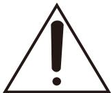
Das Ausrufezeichen im gleichseitigen Dreieck soll den Benutzer auf wichtige Bedienungs- und Wartungsanweisungen in den Unterlagen hinweisen, die dem Gerät beiliegen.
