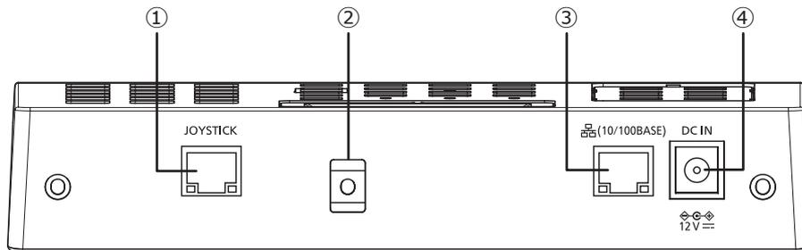
**① Steuerhebel-Steckverbinder (JOYSTICK)**
